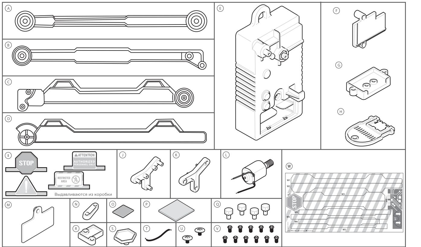
А. Стрела А; В. Стрела В; С. Стрела С; Д. Стрела D; Е. Стойка; F. Крышка мотора; G. Держатель карты; H. Ключ-карта; I. Шаблоны для карты (выдавливаются из коробки); J. Соединительная база; K. Соединительная крышка; L. Мотор; M. Крышка батарейного отсека; N. Соединитель; O. Металлическая пластина; P. Двусторонняя, вспененная клейкая лента; Q. Крышки разъемов; R. Малая соединительная крышка; S. Шестиугольная пластина; T. Черный провод; U. Винты с гайками; V. Винты; W. Стикер.
