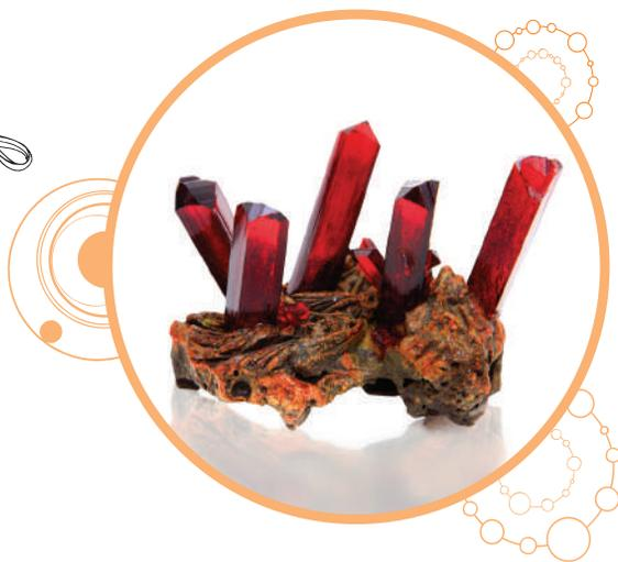
Калий гексацианоферрат используют при производстве разного рода электротехники. Кроме того, растворы вещества применяют в процессе проявления фотографий. Водный раствор этого средства нашел себе применение и в химической промышленности. Здесь его используют как реагент для обнаружения ионов железа. Кровяная соль употребляется также в пиротехнике.
