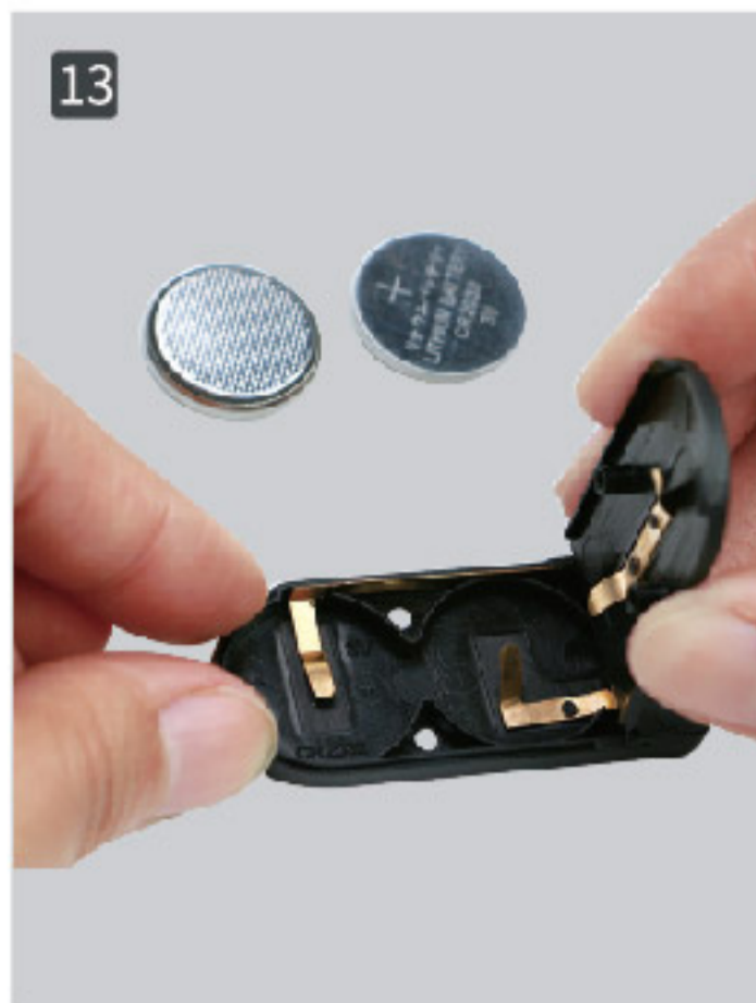
13 Вставьте батарейки (обращайте внимание на полярность).
