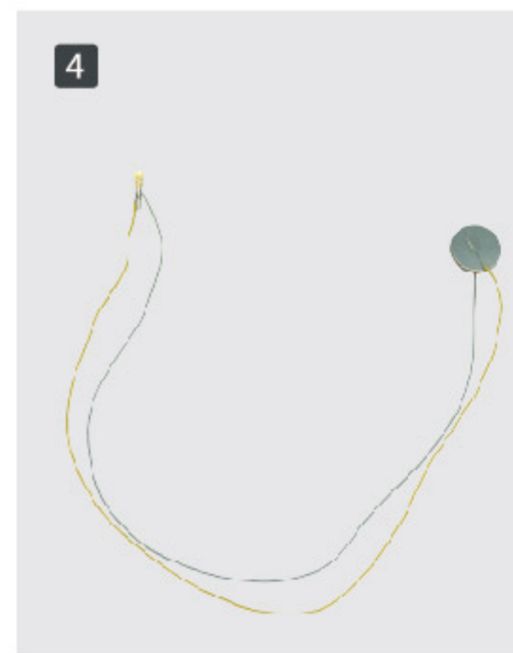
4 Протестируйте работу светильника. Обратите внимание на полярность.
