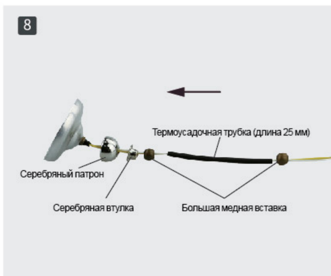
8 Проденьте провод по очереди через серебряный патрон, втулку, большую медную вставку, термоусадочную трубку (длина 25 мм), и еще одну большую медную вставку.
