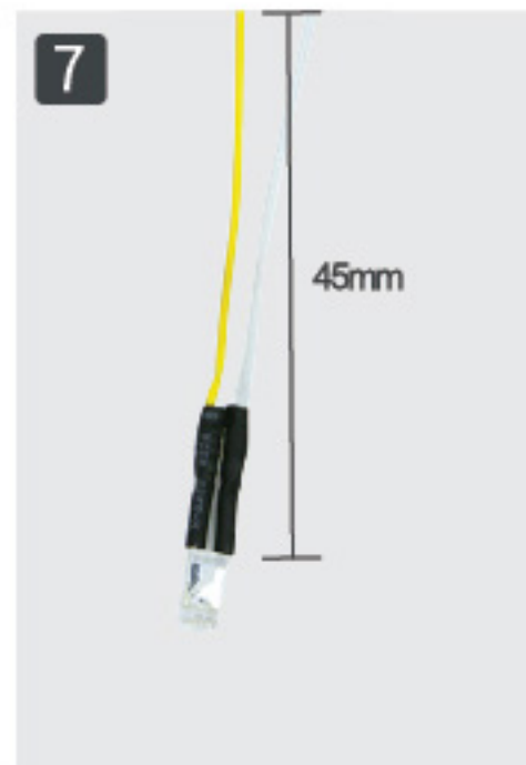
7 Укоротите провод до 45 мм.
