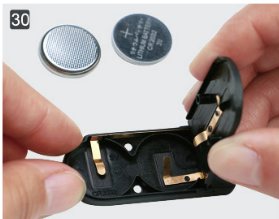
30 Вставьте батарейки в коробочку (Обратите внимание на положительный и отрицательный заряд).
