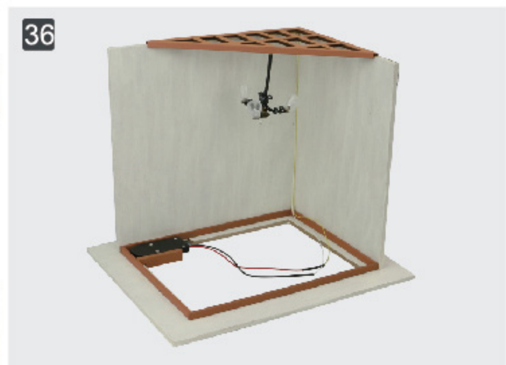
36 Поместите коробочку в положение, как на иллюстрации. Не приклеивайте, чтобы заменить батарейки в будущем.
