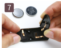
7 Вставить батарейки с учетом полярности электродов
