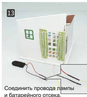
Соединить провода лампы и батарейного отсека. Желтый провод – с красным, белый – с черным. Включить лампу и убедиться в ее исправности
