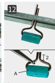
Обрезать проволоку в соответствии с размерами на рис.
