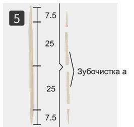
Разрезать зубочистку в соответствии с миллиметражом на рис.
