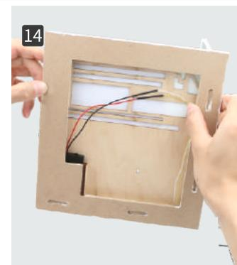
Разместить батарейный отсек так, чтобы был доступ к выключателю. Не приклеивать, чтобы была возможность заменить батарейки
