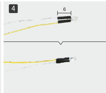
Отрезать 2 термоусадочные трубки (по 6 мм) и нагреть их зажигалкой, избегая повреждения провода
