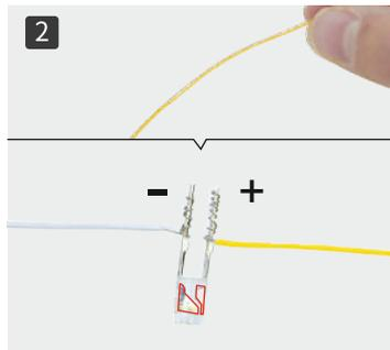
Оголить 12 мм желтого и белого провода. Соединить с диодом (Обратить внимание на полярность диода)
